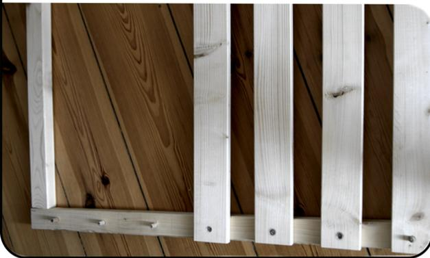
Als nächstes müssen die Rahmen B und die Latten C mit Bohrungen versehen werden, sodass letztere auf die Holzdübel aufgelegt werden können.
