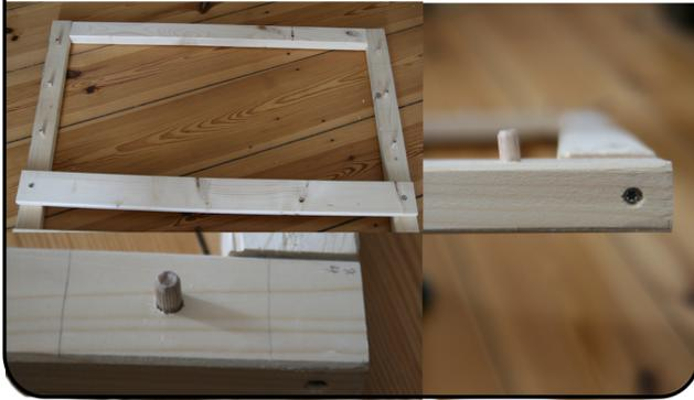
Der Rahmen wird zusammengesetzt, indem A und B jeweils mit einem Holzdübel und einer Schraube fixiert werden. Dazu wird mit dem passenden Holzbohrer ein Loch für den Holzdübel gebohrt, und zwar so, dass die Tiefe in beiden Holzstücken jeweils der Hälfte der Dübellänge entspricht (= 2cm).
