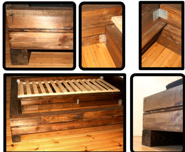
Im letzten Schritt folgt eine weitere Ebene bestehend aus den Balken A und D. Diese werden mit Dübeln auf den Brettern befestigt und zusätzlich innen in allen vier Ecken mit Winkeln stabilisiert.
